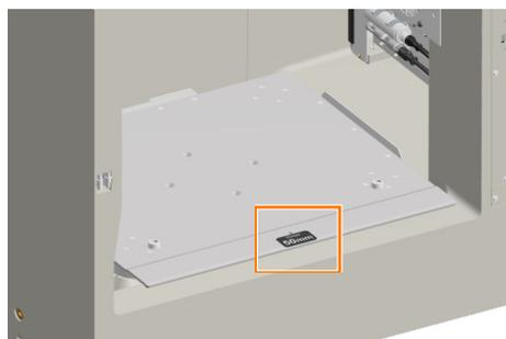
Sur la table d'agitation, sur le devant au milieu, se trouve un adhésif permettant d'identifier l'excentration d'agitation (*Throw*) de l'appareil concerné.
