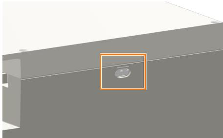
Une ouverture pour la ventilation de l'espace intérieur est située en haut au centre de l'arrière du boîtier. La ventilation sert à alimenter les cultures bactériennes avec l'oxygène issu de l'air.
