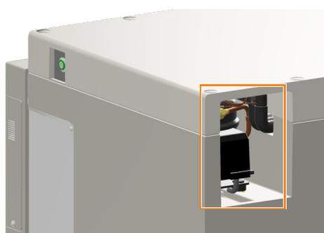
Pour les processus nécessitant des températures nettement inférieures à cette température, l'appareil peut être équipé d'un refroidissement interne. L'unité de refroidissement est installée au dos de l'appareil, vu de face, en haut à droite. Avec ce refroidissement, il est possible d'atteindre des températures allant jusqu'à 16 °C en dessous de la température ambiante, avec un minimum de 4 °C.
