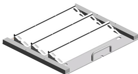
Plateau avec pinces inclinées avec un angle de 20° (incubation inclinée) : la barre de serrage inclinée est une tôle en forme de plaque avec deux profilés. Le profilé inférieur est une barre coudée (3). Le profilé supérieur est un profilé en U dans lequel un cordon en caoutchouc cellulaire (2) est inséré. Deux entretoises (1) se trouvent sur le profilé supérieur afin de positionner les plaques de microtitration ou les plaques à puits profonds.
