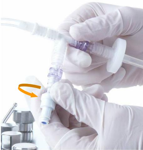
3. Tourner la vanne de prélèvement à la main, avec précaution, dans le sens des aiguilles d'une montre, afin de la fixer.
