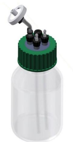
La figure à gauche illustre un flacon de réactif à 3 + 1 raccords.
