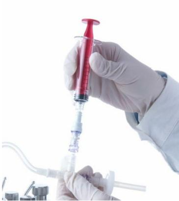
5. Tourner la seringue Luer-Lock pour la fixer sur la vanne de prélèvement.
