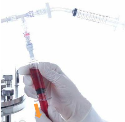
1. Maintenir la seringue avec l'échantillon vers le bas, tirer le piston vers l'arrière.
