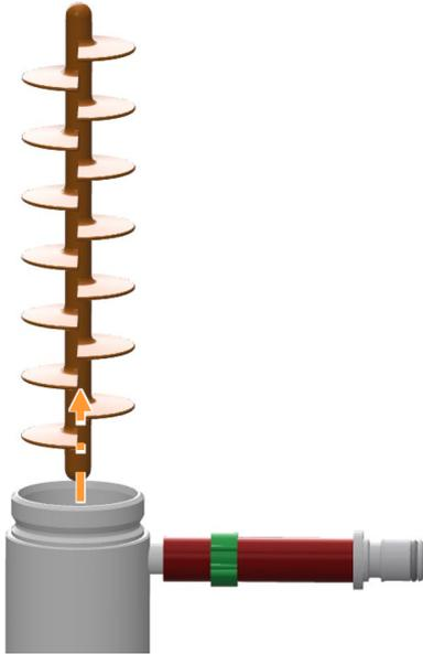
5. Retirer la chicane en silicone condenseur de gaz de sortie.
