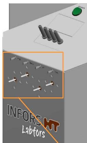
Les arbres d'entraînement des pompes se trouvent en haut, à l'avant de la console de l'appareil de base. Le sens de rotation des arbres d'entraînement est en général le sens horaire. Des interrupteurs à bascule pour l'actionnement manuel des pompes se trouvent au-dessus des arbres moteur. Ils sont étiquetés de la façon suivante, de gauche à droite :
