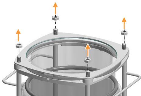
3. Desserrer et retirer à la main les quatre contre-écrous de l'anneau en acier inoxydable.
