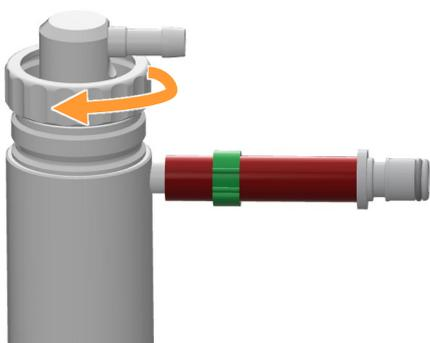
3. Mettre en place l'écrou-raccord et le visser à la main dans le sens des aiguilles d'une montre.
