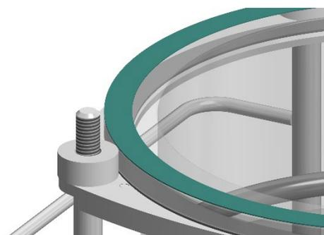
7. Veiller à ce que la bague d'amortissement soit correctement placée sur le collier de la cuve et qu'elle ne se déplace pas. La bague d'amortissement ne doit pas chevaucher le bord extérieur de la cuve.
