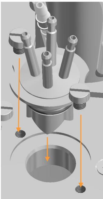
1. Insérer l'insert d'ajout quadruple avec le joint torique dans le port.
