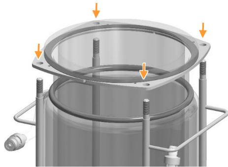
4. Abaisser la cuve en verre sur le support au niveau de la bride de cuve en deux parties et insérer les tiges du support de cuve dans les trous filetés de la bride de la cuve. Poser soigneusement la cuve à terre
