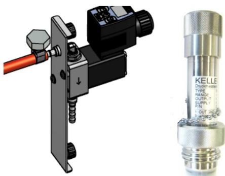
La régulation de pression est constituée d'une électrovanne (vanne de dosage) et d'un capteur de pression piézorésistif avec un joint torique (celui-ci n'est pas représenté).
