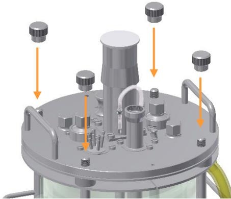
Quatre écrous moletés servent de fixation du couvercle à la cuve et au support de la cuve. Le moyeu d'entraînement avec l'accouplement du moteur se trouve au milieu de la cuve.
