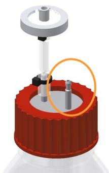
4. Placer les flacons de réactif dans les supports de flacons et de pompes.
