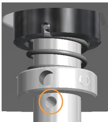
1. Insérer par exemple une clé Allen ou une barre de métal fine dans le trou à l'extrémité supérieure de l'arbre d'agitation. De cette manière l'arbre d'agitation est bloqué.
