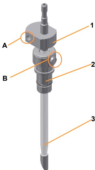
Si commandée, une sonde antimousse pour le montage dans un port de Ø 10 mm du couvercle de la cuve est fournie par défaut. Un manchon de blocage à joint torique est utilisé pour le montage.
