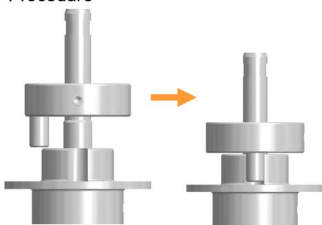
1. Tourner la goupille cylindrique au niveau de l'anneau manuel sur le renforcement dans la gaine stérile.
