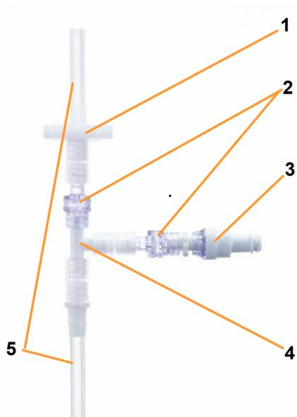
Le système de vannes comprend une pièce en T, 2 vannes de retenue, 1 vanne de prélèvement, 1 filtre stérile, 1 tuyau servant d'adaptateur pour la seringue et un autre tuyau servant de raccord avec le tube plongeant pour le raccordement à la cuve de culture.
