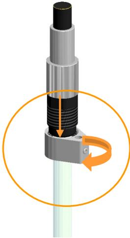
4. Introduire la sonde dans la vis creuse (filetage vers le bas).
