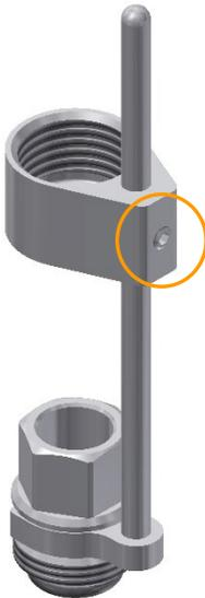
1. Sur le porte-sonde, desserrer légèrement la vis sans tête dans la douille avec une clé.
