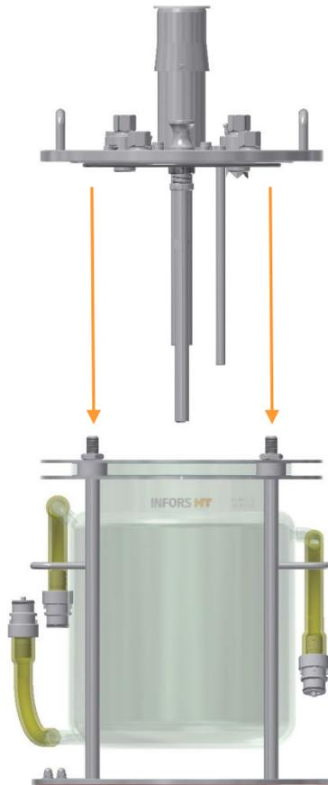
1. Positionner avec précaution le couvercle correctement orienté.
