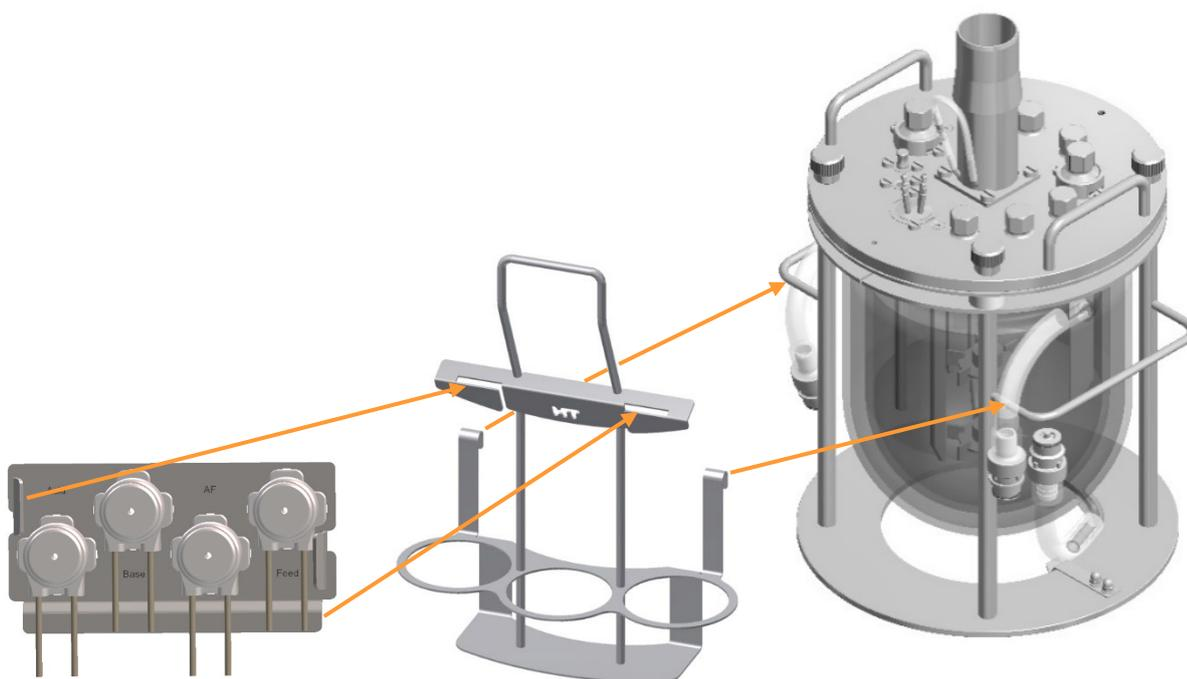
Le support de flacons de réactif peut être accroché au support de cuve. La plaque de montage munie des têtes des pompes peut être placée sur le support de flacons de réactif et de pompes.
