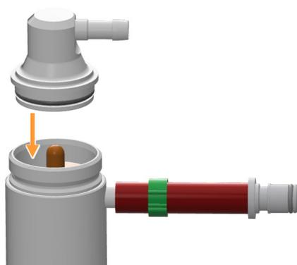
2. Poser à la main le couvercle avec joint torique intact à la verticale sur le condenseur de gaz de sortie.
