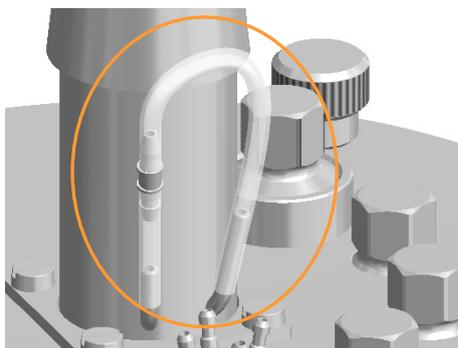
Pour cette raison, toujours vérifier et s'assurer que le tuyau en silicone au pied du moyeu d'entraînement est totalement rempli de glycérine. Au besoin, le remplir.
