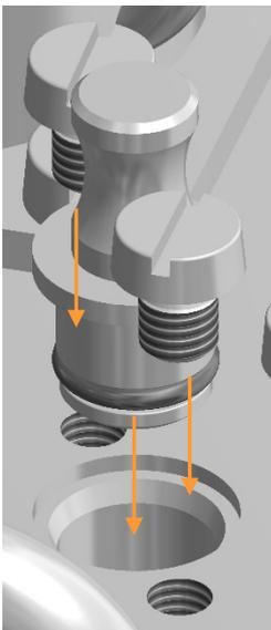
1. Insérer le bouchon avec joint torique dans le port.
