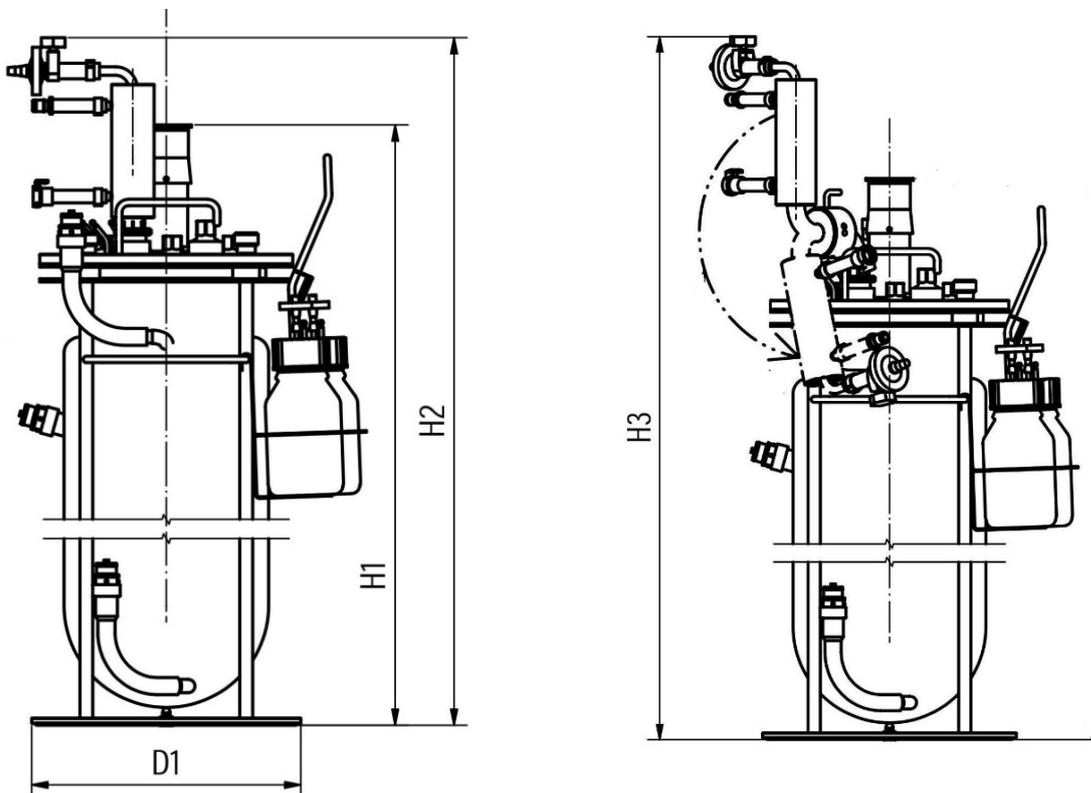
Les figures montrent, à titre d'exemple, la cuve de culture avec condenseur de gaz de sortie standard (à gauche) et avec condenseur de gaz pivotant (à droite), les deux avec support de flacons de réactif et de pompes.
