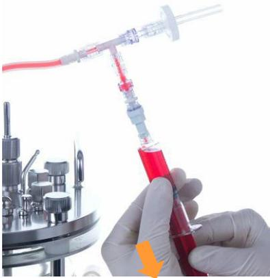
6. Tirer le piston de la seringue en arrière pour prélever le volume d'échantillon souhaité.
