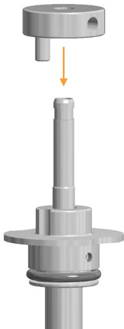
5. Pousser l'anneau manuel sur le diffuseur de gaz, jusqu'en butée (pas au-delà).
