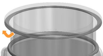
9. Retirer la bague d'amortissement noire du collier de la cuve.
