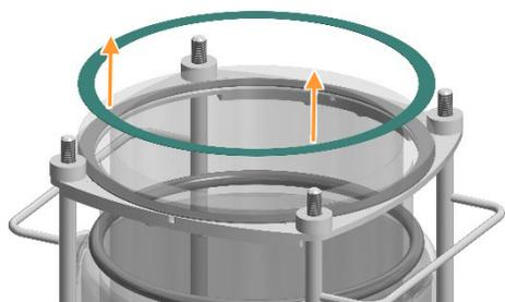
5. Retirez la bague d'amortissement verte du collier de la cuve.
