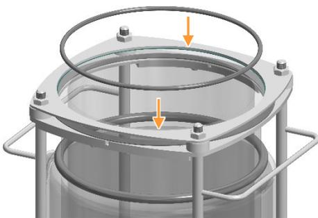
10. Insérer le joint torique (joint du couvercle). Le joint torique doit reposer complètement sur le bord légèrement saillant de la cuve en verre de l'anneau en acier.
