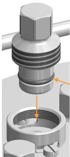
2. S'assurer que chaque composant est équipé d'un joint torique intact : vérifier les joints toriques pour voir s'ils sont bien en place et intacts ; au besoin, les ajuster ou les remplacer.
