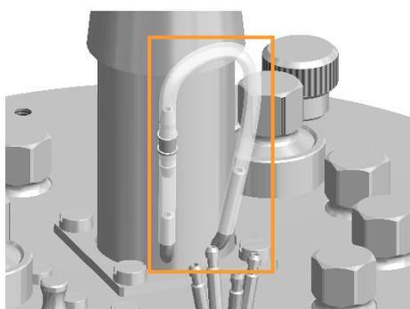
Le joint mécanique d'étanchéité doit toujours être lubrifié. Pour ce faire, il se trouve deux inserts d'ajout fixe équipés d'un tuyau en silicone au moyeu d'entraînement.
