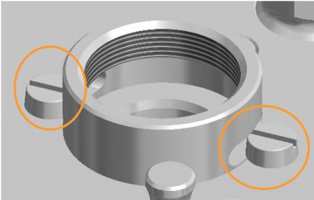
1. Positionner l'adaptateur fileté avec la bonne orientation sur le port de 19 mm.
