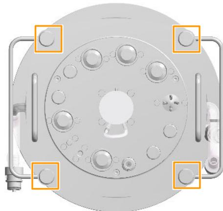
a) Tournez légèrement les quatre écrous moletés avec deux doigts jusqu'à ce que les écrous touchent le couvercle de la cuve. Ne pas serrer les écrous moletés à ce stade !
