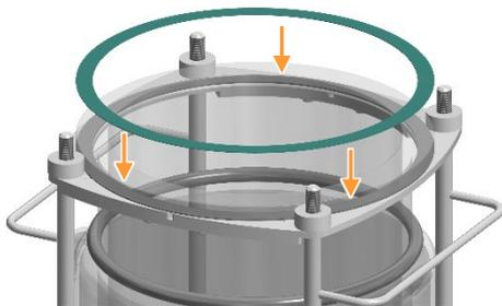
6. Placer la deuxième bague d'amortissement (verte) sur le côté supérieur du collier de la cuve.
