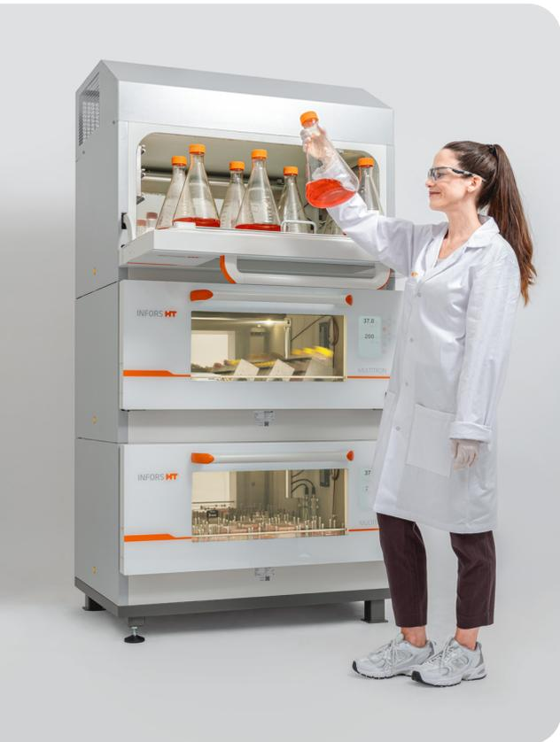
L'incubateur agité Multitron offre une performance fiable et à haut débit dans un design compact. Conçu pour un fonctionnement continu et un nettoyage facile, il permet des cultures microbiennes et cellulaires uniformes et exemptes de contamination.
