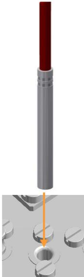
1. Den Sensor bis zum Anschlag in die Tauchhülse im Deckel einföhren.
