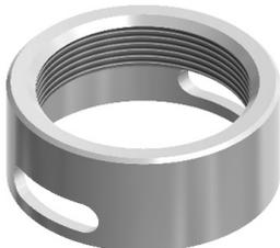
Ein Gewindeadapter verfügt über ein Innengewinde und wird für die Montage von Blindstopfen oder Klemmstutzen mit Ø 19 mm in einen (gewindelosen) 19 mm Port im Gefäßdeckel verwendet.
