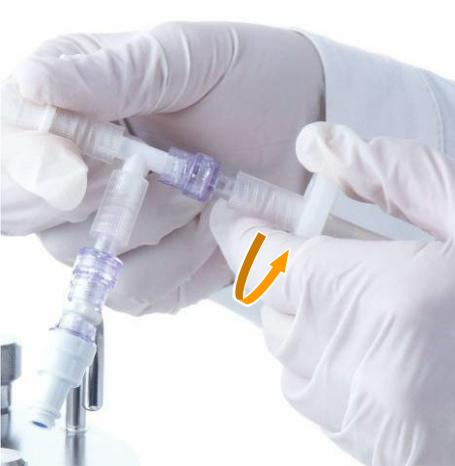
4. Sterilfilter vorsichtig von Hand im Uhrzeigersinn drehen. Damit ist die Schraubverbindung Rückschlagventil/Sterilfilter fest.
