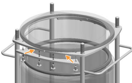
7. Nur für Gefäße mit NW200: Die beiden Teile des Gefäßflansches beidseitig mit den Verbindungsplatten (8 x M5x10 Schrauben) befestigen. Nur die mitgelieferten Originalschrauben dazu verwenden.
