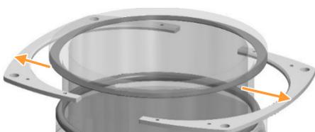
9. Den zweiteiligen Gefäßflansch entfernen.
