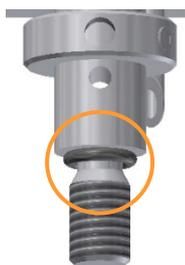
3. Rührwelle mit Schraubenschlüssel gegen den Uhrzeigersinn drehen, bis sie von der Antriebswelle gelöst ist.
