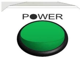
Der Netzschalter, ein grüner Wippschalter, befindet sich zuoberst auf dem Grundgerät. Er ist mit **POWER** beschriftet und leuchtet sobald das Gerät eingeschaltet ist. Neben dem normalen Ein- und Ausschalten dient der Netzschalter auch als Notschalter.
