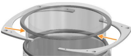
5. Die beiden Teile des Gefäßflansches unter den Gefäßkragen bringen und in dieser Position halten. Die abgeschrägte Kante der beiden Flanschteile muss nach oben zeigen.
