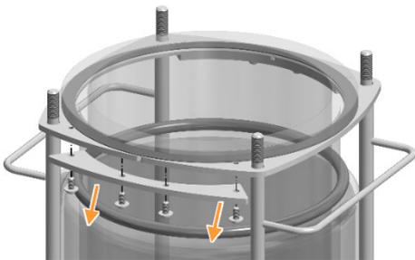
7. Nur Gefäße mit NW 200: beidseitige Verbindungsplatten des zweiteiligen Gefäßflansches vor oder nach dem Herausheben des Glasgefäßes aus dem Halter entfernen:
