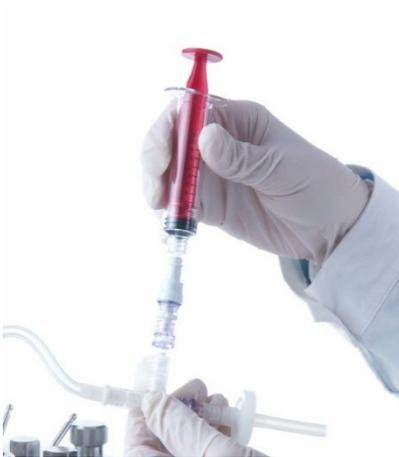
6. Kolben der Spritze zurückziehen, um gewünschtes Probavolumen zu entnehmen.
