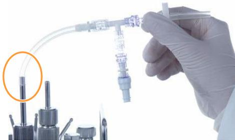
2. Schlauch mit Kabelbinder sichern.
