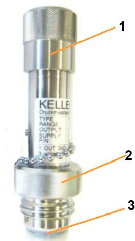
Der Drucksensor wird in einen 19 mm Port im Gefäßdeckel montiert. Zur Montage dient ein Gewindeadapter (siehe Hauptkapitel „Zubehör“).
