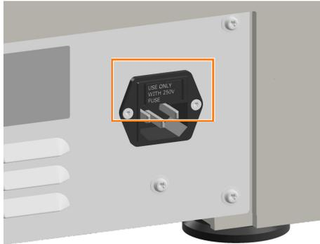
El dispositivo está protegido contra un consumo de corriente inadmisiblemente alto mediante dos fusibles. La ranura para los fusibles se encuentra justo encima de la conexión a la red en el lado derecho de la carcasa, debajo de la inscripción *MA/VS*. Para obtener información sobre los fusibles que se deben utilizar, en función del tipo de dispositivo, véase ➔ Capítulo 12.2.3 «Valores de conexión y de potencia eléctrica» en la página 113.
