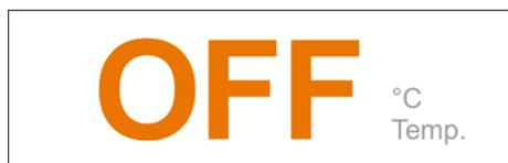
La desactivación de un parámetro funciona de forma análoga a la activación. El parámetro deseado se puede seleccionar pulsando el botón **Desplazar** y, a continuación, desactivar con el botón **ON/OFF**. Si un parámetro se ha desactivado, aparece en el cuadro de visión el mensaje *OFF*.
