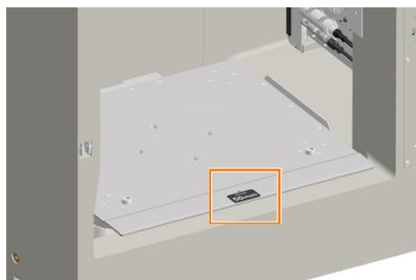
Sobre la mesa agitadora, en el centro de la parte delantera hay un adhesivo para la identificación del diámetro de órbita (*Throw*) del dispositivo en cuestión.
