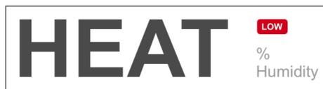
Para evitar la condensación en las paredes del interior, el evaporador activará el control de la humedad cuando se alcance el valor nominal de la temperatura ( $\pm 1$  °C). Después de activar el parámetro y alcanzar el valor nominal de la temperatura, pasarán unos 5 minutos hasta que el evaporador se caliente. Durante este tiempo, se mostrará de forma alterna el valor real de la humedad y el mensaje *HEAT*.
