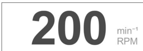
El parámetro de velocidad de rotación (*RPM*) se puede controlar mediante el panel de operación. Para obtener información sobre el ajuste y la activación del parámetro, véase → Capítulo 7.3 «Ajuste, activación y desactivación de parámetros» en la página 76.
