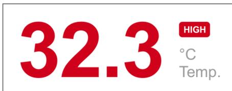
Una alarma de parámetro se emite cuando el valor real de un parámetro se desvía mucho del valor nominal tras un tiempo de espera establecido. En el ejemplo de la izquierda, la temperatura es demasiado elevada. La desviación máxima permitida respecto al valor nominal y el tiempo de espera vienen definidos de fábrica y no se pueden modificar.
